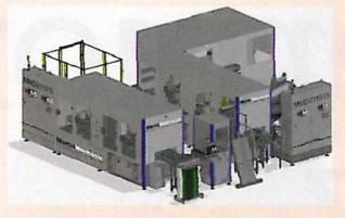
eines stattlichen Einfamilienhauses hat, werden mit Hilfe von elf Robotern Dämpfungssysteme für Schiebetüren an Fahrzeugen montiert. Bei einer Zykluszeit von sechs Sekunden arbeitet die Automationszelle trotz ihrer vielfältigen Aufgaben enorm schnell.
