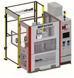
Endmaß zu und schärft sie anschließend präzise. Damit die Grundplatte immer komplett bearbeitet werden kann, dreht sie sich nach jedem Bearbeitungsschritt um ein Zwanzigstel von 360 Grad. Nach zwanzig Schleifvorgängen ist sie wieder an ihrem Ausgangspunkt angelangt.
