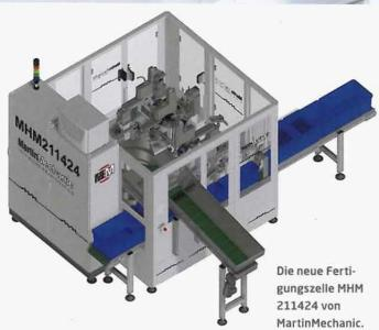
DIE GESCHWINDIGKEIT, mit der die drei Scara-Roboter von Yamaha in der sechs Quadratmeter großen Fertigungszelle MHM 211424 wirbeln, ist enorm. Vor allem wegen ihrer Geschwindigkeit, aber auch wegen ihrer Präzision Wiederholgenauigkeit zwei Hundertstelmillimeter - hat sich MartinMechanic für Scaras dieser Marke entschieden. In einer Zykluszeit von sechs Sekunden bestücken sie Steckverbinder mit maximal je fünf Kontaktstiften, verpressen sie und prüfen auch noch deren Qualität.
