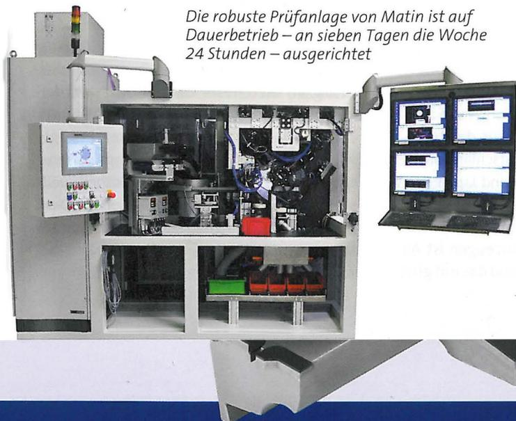
Vom Bunker aus durchlaufen die Bauteilchen mit einer Taktzeit von 3,6 Sekunden die Prüfanlage, um am Ende in fünf Kategorien sortiert zu werden. Über den Vibrationsfördertopf bekommt die erste Kamera das Teil vor ihre Linse und erkennt seine Lage. Die Vereinzelnung übergibt es lagegenau in einen Doppelgreifer, der es in den Rundtisch legt. Dieser dreht sich und schwenkt automatisch, wodurch die sensible Kamera die Dichtfläche genau analysieren kann.
