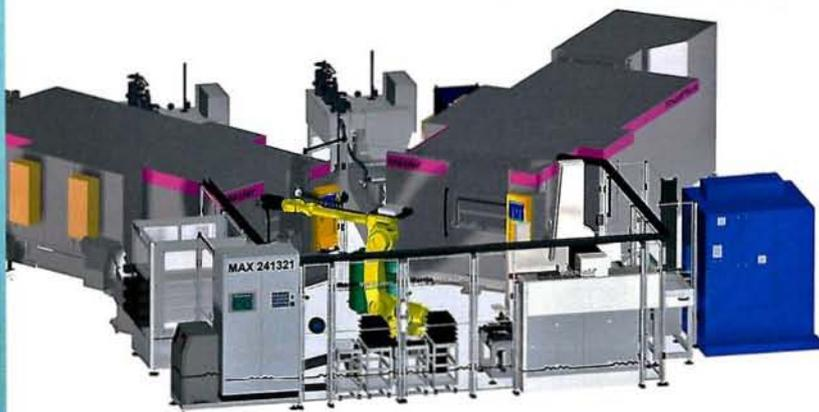
*Der Roboter ist ein Multitalent, er bedient sieben Stationen gleichzeitig*
