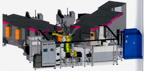
Der Roboter in der neuen Fertigungsinsel Max 241321 bedient sieben Stationen gleichzeitig (Foto: MartinMechanic)
