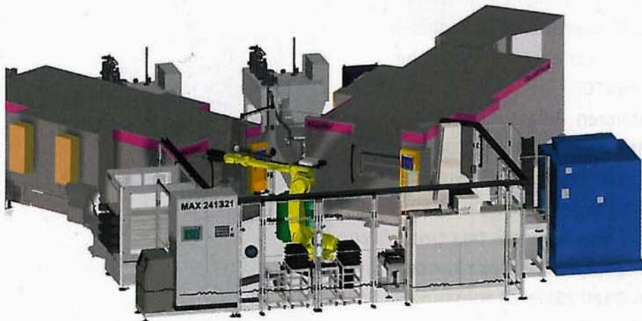
der Bediener in den Bearbeitungsprozess manuell eingreifen. Von ihm werden die Zuführstrecken, die auf mehreren Ebenen nebeneinander liegen, von Hand mit den Lagergehäusen bestückt. In diesem Fall wird gut eine halbe Tonne Rohmaterial über Staurollen in den Umlauf der Fertigungsinsel gebracht. Dazu werden die Teile von Hand auf die Kettensegmente gelegt. Am Ende der Fertigungskette nimmt der Maschinenführer den beladenen Fertigteilwagen per Hand in Empfang.
